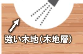
エア-鉋は、圧縮空気と植物性粉体を対象物に噴射することで、従来の「洗う」「削る」工法では取り除けなかった「痩せ部」凹み部の劣化層や脆弱層を取り除くことができます。
